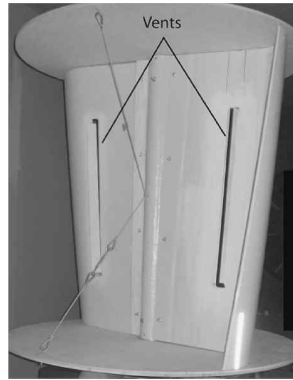
<그림 4-6> 사보니우스(capped and vented) 풍력터빈 (2)
